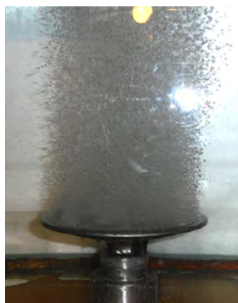
Образование пузырьков воздуха в воде на поверхности пористого диска аэратора при номинальном расходе воздуха
